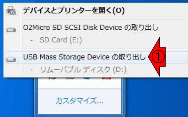
USBメモリとPC間で何かデータのやり取りをしている最中に、手でいきなり引き抜くという物理的な取り外しは危険である。そのため、USBメモリを取り外したい場合には、一般にいきなり手で引き抜く(物理的な取り外し)前に、画面右下にあるタスクトレイから目的の「USBメモリの取り出し」を行う。これはPC側からの認識を解除(アンマウント、という)していることに相当し、物理的な取り外しの対比的な用語として、論理的な取り外しという表現がなされる。
