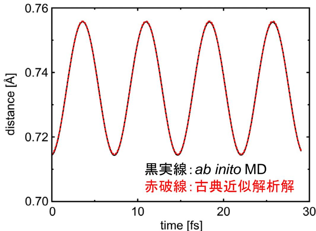
ポテンシャルエネルギーを量子化学計算を用いて求める代わりに、エネルギー関数を用いて近似しても、ほぼ同じ軌道が得られる
