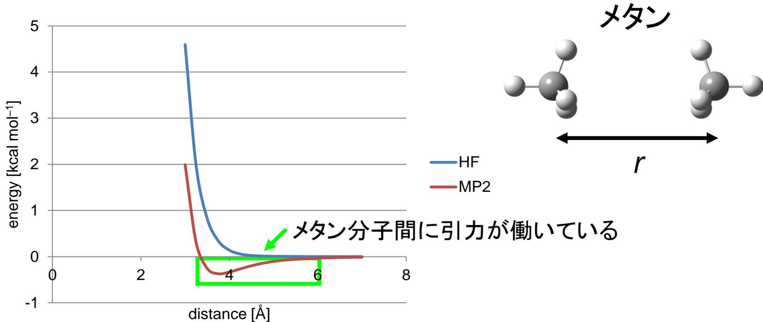
無極性分子間に働く引力(分散力)は、電子相関を考慮した高精度な量子化学計算によって初めて現れる
